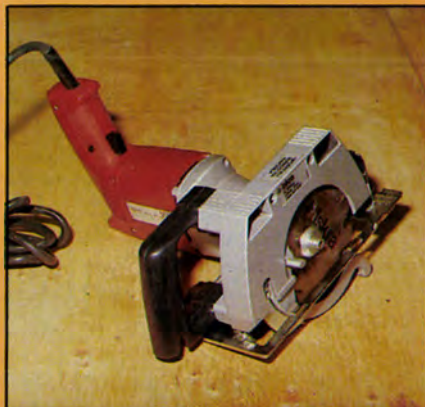
KZ-140 Körfűrész (45°-nál a vágási mélység 32 mm)
